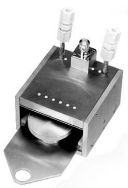
Рисунок 3.4 – Принципова схема і зовнішній вигляд сучасного газо-проточного пропорційного детектора
