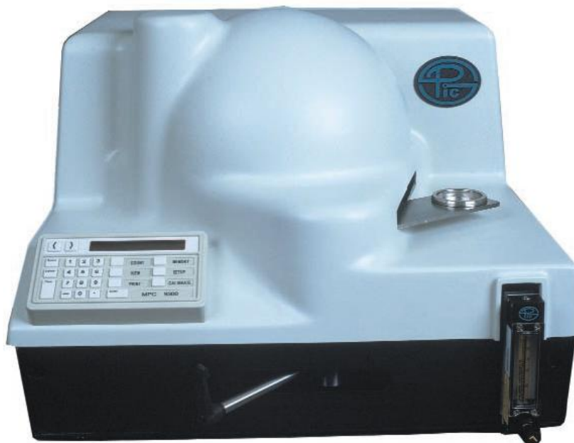
Рисунок 3.5 – Зовнішній вигляд сучасного альфа/ бета-радіометра з газо-проточним пропорційним детектором MPC 9300 (Ortec, USA)
