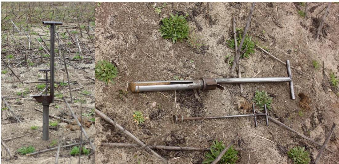
Fig. 1.6.. Sampler 37 mm (0,001 m<sup>2</sup>)
