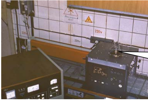
Внешний вид установки лазерного пробоотбора с поверхности микровэлов ВТГР
